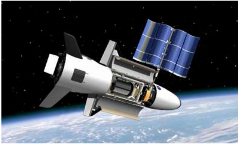
X-37B: panely slunečních článků z GaAs
