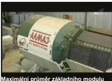
Maximální průměr základního modulu stanice byl 4,15 m, a délka přibližně 13 m
